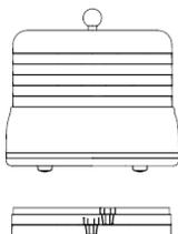
Чтобы опустить верхнюю секцию в нижнюю, поворачивайте секции так, чтобы пластиковые «язычки» изнутри нижних краев верхней секции располагались рядом с вертикальными пластиковыми пазами в верхней части нижней секции.
