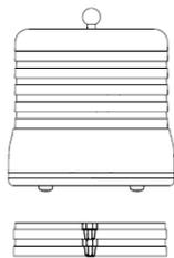
Чтобы установить максимальную высоту, выровняйте пластиковые «язычки» изнутри нижних краев верхней секции относительно вертикальных пластиковых пазов в верхней части нижней секции.
