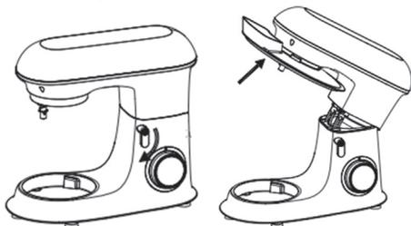
Нажмите сверху на верхний блок миксера и поверните фиксатор верхнего блока по часовой стрелке, после этого верхний блок автоматически поднимется. Закрепите крышку чаши на верхнем блоке, как показано на рисунке.
