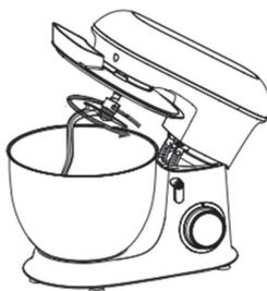
Плавнo опустите верхний блок с насадкой вниз, пока блок не зафиксируется в горизонтальном положении. При опускании блока следите, чтобы не прищемить пальцы крышкой.
