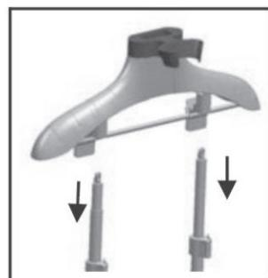
Установите на верхние концы телескопических трубок плечики для одежды с держателем насадки для отпаривания.
